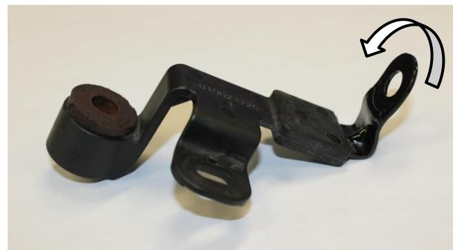
42. Re-install OEM fan connector bracket to fan clutch.
